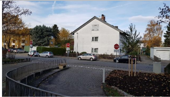
Beschilderung und Haltelinie zur Verbesserung der Verkehrssicherheit für Zufußgehende an Tiefgaragenausfahrt (Foto: gewobau Rüsselsheim)
